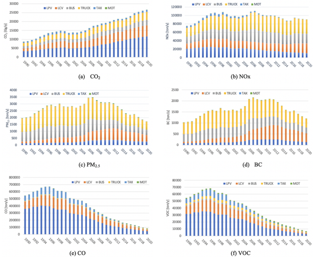
Figura 1.15: Tendencias de las emisiones anuales totales de escape según tipo de vehículo en Chile, 1990-2020. Fuente: Osses et al. (2022) Earth System Science Data, 14, 1359-1376.
