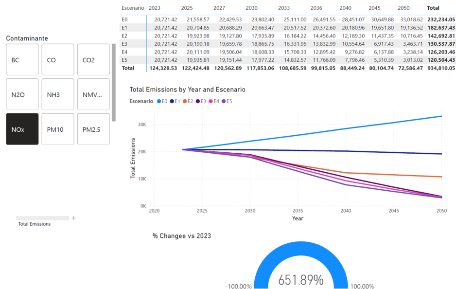
Figura 5.41: Panel de proyección temporal comparando el escenario inercial (E0) frente a las sendas de mitigación (E1 a E5). Se observa el punto de quiebre estructural en la curva de emisiones al aplicar regulaciones estrictas.
