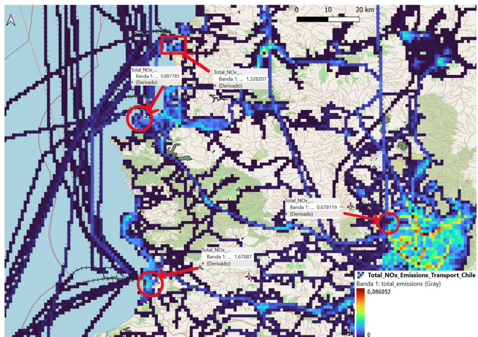
Figura 3.89: Verificación de los valores de emisión acumulados de NOx (Gg) en puertos y aeropuertos clave, demostrando la integridad matemática del ráster consolidado.
