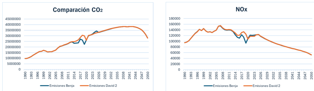
Figura 5.4: Contraste de proyecciones absolutas (1990-2050). Izquierda: Dióxido de Carbono ( CO_2 ). Derecha: Óxidos de Nitrógeno ( NO_x ). Las series temporales ratifican la estabilidad del cálculo en ambos extremos del espectro de combustión.
