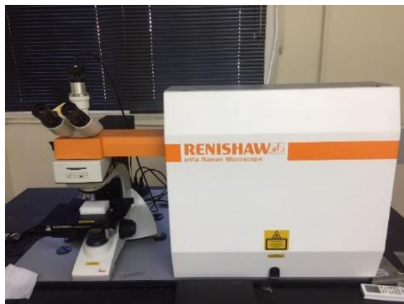
Figura 3.7 Equipo de Espectroscopia Raman: Raman Renishaw InVia Reflex equipado con un Microscopio Leica DMLM.
