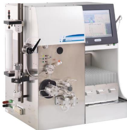
Figura 12 Sistema de purificación flash Gilson (fuente: https://www.gilson.com/plc-purification-systems.html )
