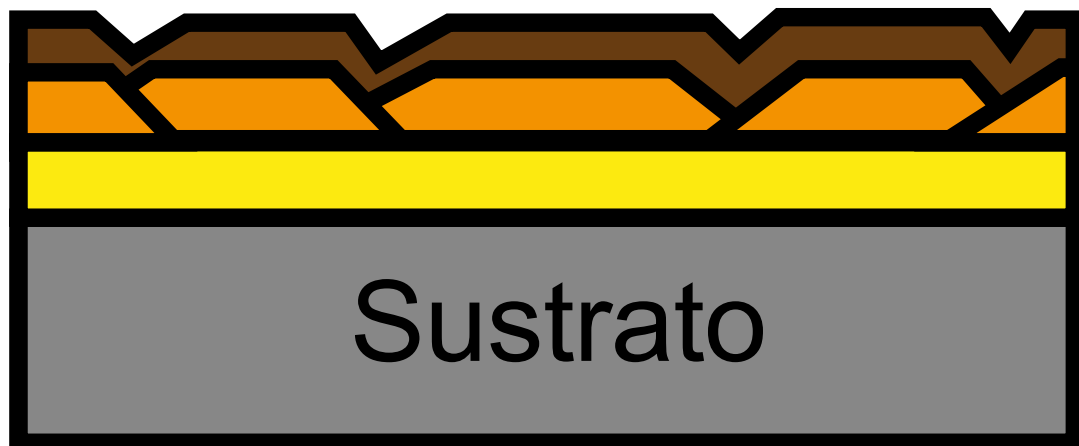
Figura 46: Esquema de las tres estructuras de una película ultradelgada de cromo: óxido (café), naranja (granos), amarillo (monocapas).
