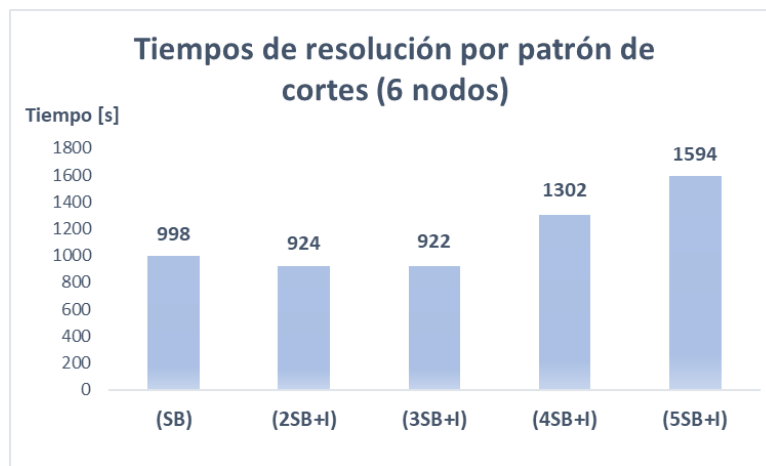
Figura 6.4. Tiempos de resolución de patrones de cortes para caso de estudio 3, sistema IEEE 6 nodos.
