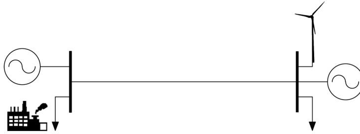
Figura 5.1: Sistema de ejemplo de dos nodos, para explicar el efecto de la generación eólica sobre el sistema.
