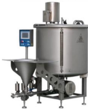
Figura 3: Producción de marinado: Tanque de agitación [11].
