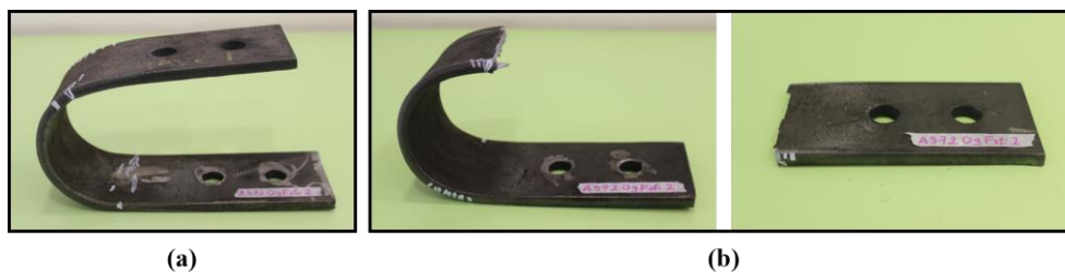
Figura 22. Falla del ensayo A5720GFati2. (a) UD 1, (b) UD 2
