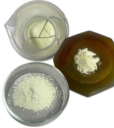
Figura 3.1: Etapa final de la síntesis del catalizador de bismuto en fase Alpha.
