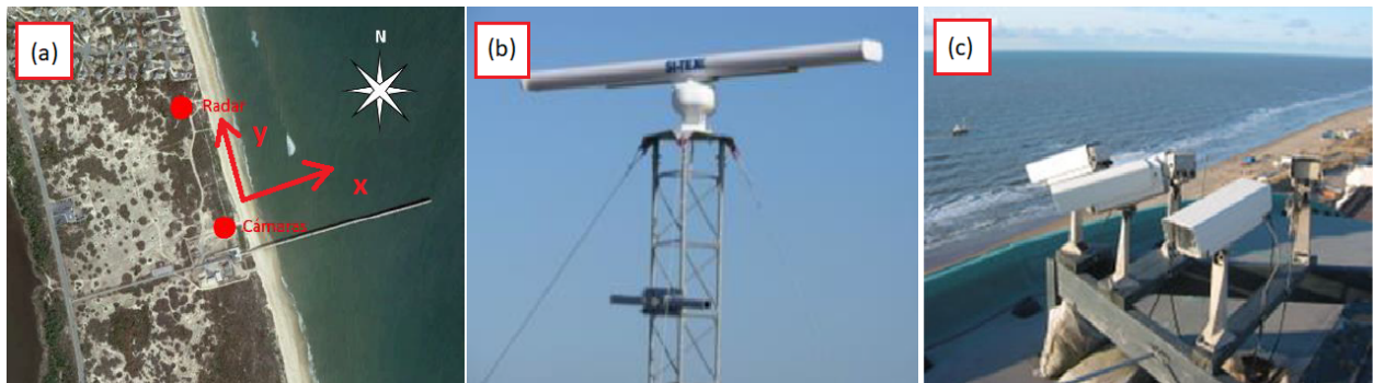
Figura 2.2: Posición y ejemplo de las plataformas de teledeceión utilizadas. a) Corresponde a la posición geográfica de los intrumentos, b) y c) son fotografías del radar y sistema de cámaras utilizado
