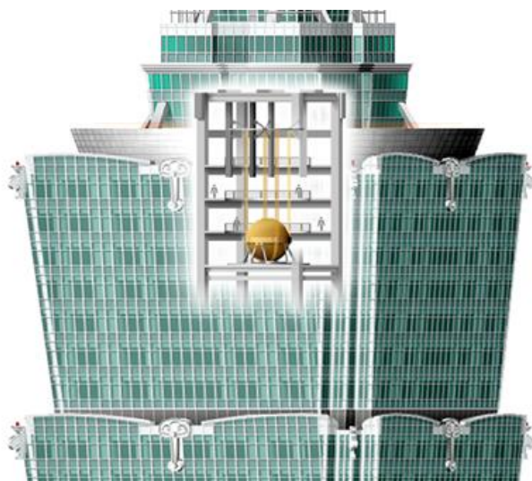
Figura 2.1: Ubicación del Amortiguador de Masa Sintonizada en la Torre Taipei 101, Taiwán. Fuente: https://upload.wikimedia.org/wikipedia/commons/1/15/Taipei_101_Tuned_Mass_Damper.png
