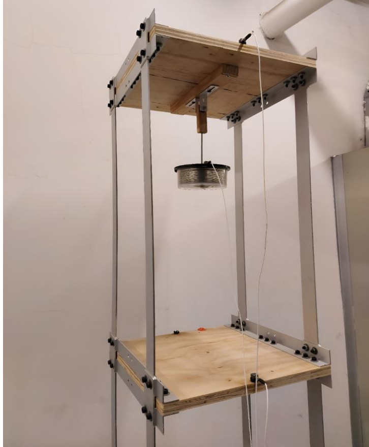
Figura 5.3: Ubicación acelerómetros ensayo estructura con AMS.
