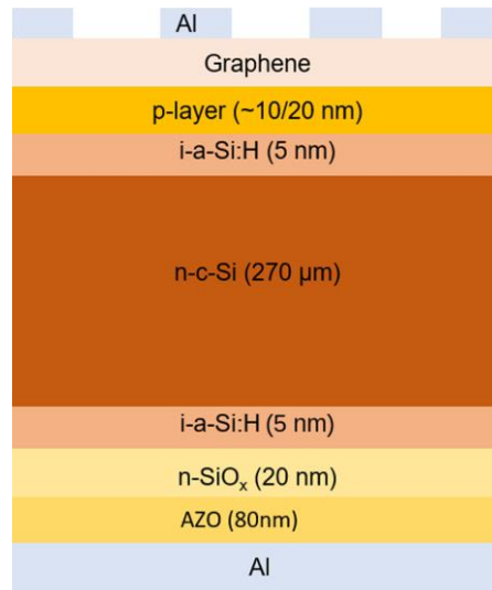
Figura 8: Esquema de la celda de SHJ con grafeno como TCF estudiada en [4]
