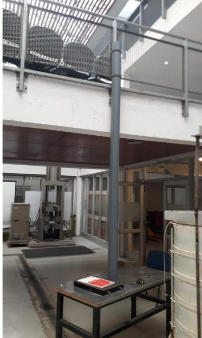
Figura 3-7: Tubo con columna de agua de 3 metros para verificación de sensor de presión de agua.
