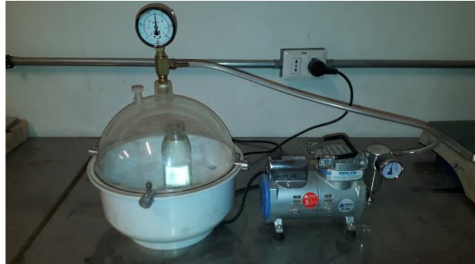
Figura 3-8: Aplicación de vacío para extracción de burbujas de aire de glicerina.
