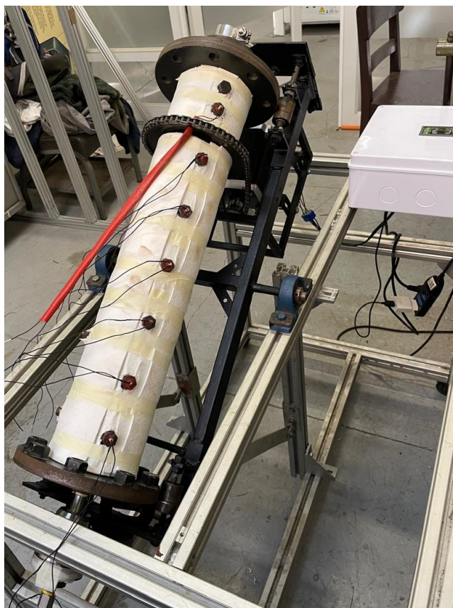
Figura 3.2: Closeup del reactor, aislamiento reemplazado.
