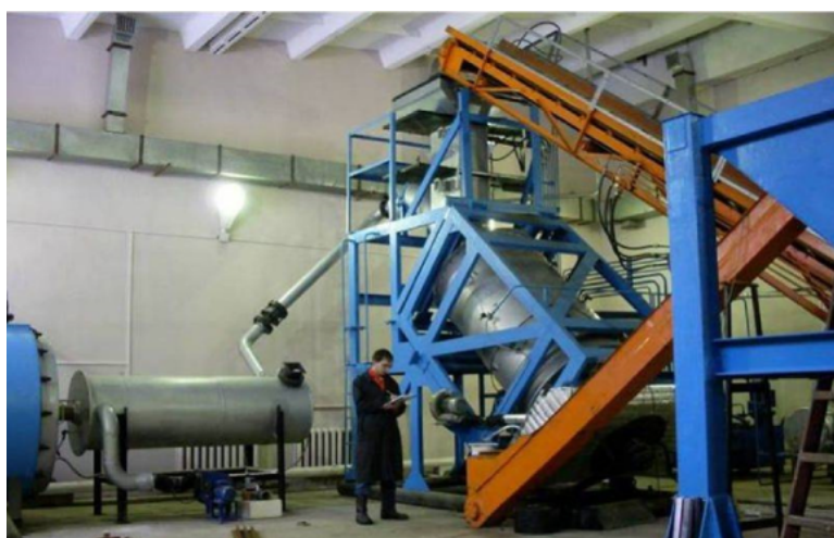
Figura 2.6: Reactor inclinado rotatorio aplicado en escala industrial [4]
