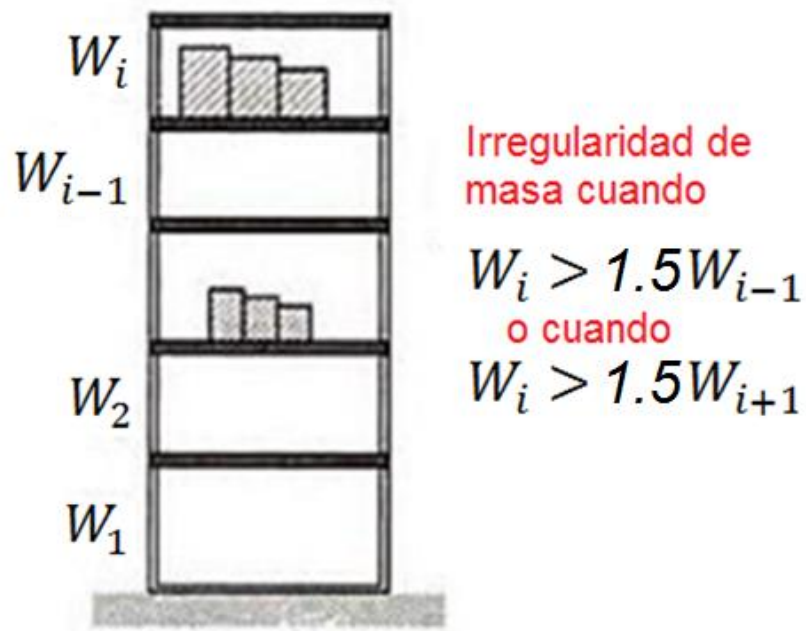
Figura 9.19 Esquema de irregularidad de masas según ASCE 7, 2010
