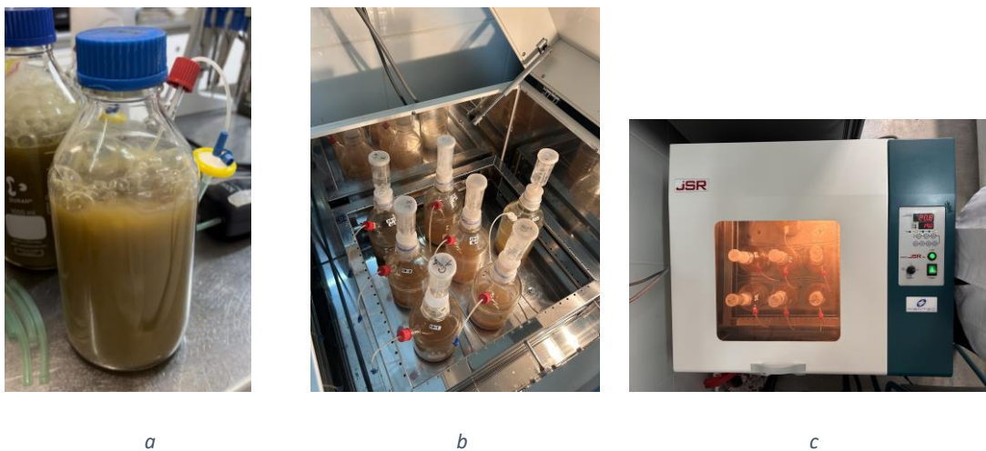
Figura 32. a. Frasco Schott modificado con su toma muestra durante la etapa de aireación. b. Fermentadores durante la etapa de maceración prefermentativa, día de montaje. c. Fermentadores en el shaker durante etapa de fermentación alcohólica.
