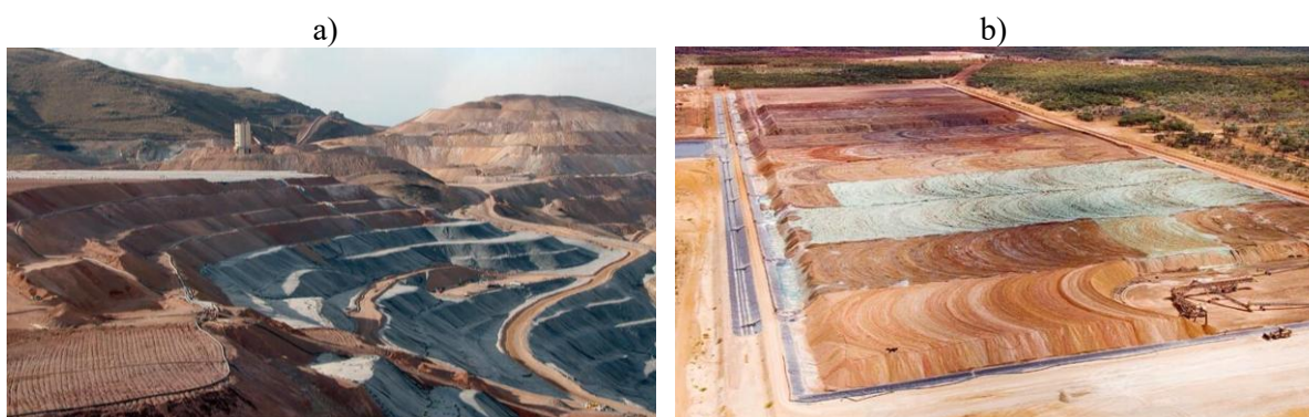
Figura 3: Ejemplos de pilas de lixiviación utilizadas en minería del cobre: (a) pila permanente o estática ( dedicated pad ), y (b) pila dinámica ( reusable pad o on/off ). Adaptado de Melo (2018).
