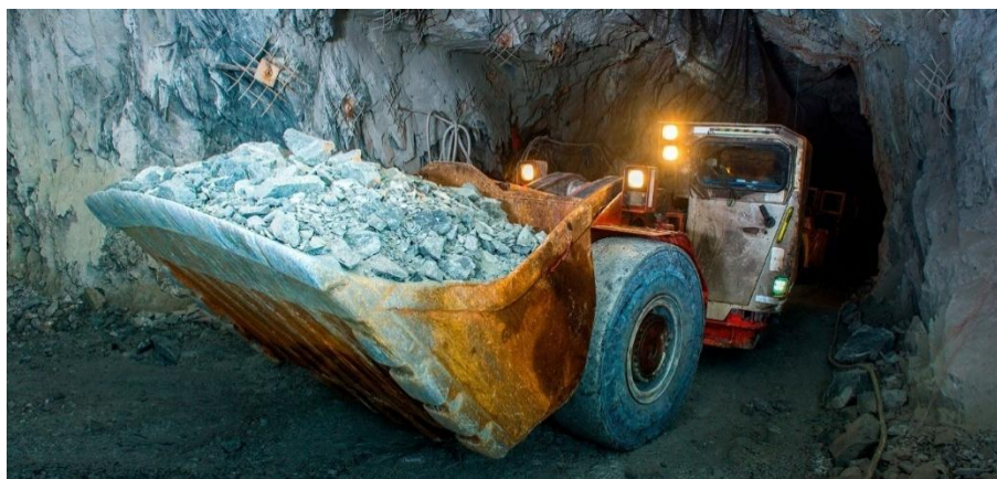
Figura 2: Extracción y transporte de estéril de mina durante una operación minera subterránea. Fuente: País Minero (2022).
