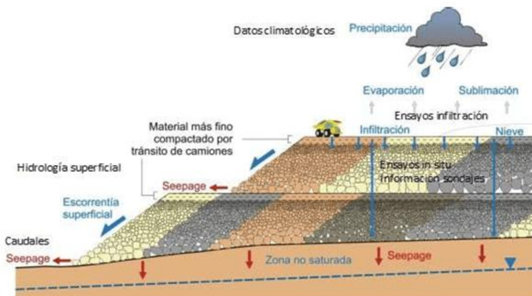
Figura 6: Desarrollo y migración del drenaje ácido de roca en un botadero de estériles. Esquema conceptual de generación y transporte de drenaje ácido de roca en un botadero de estériles. La infiltración de agua proveniente de precipitación, nieve o escorrentía superficial ingresa al depósito y circula a través de la zona no saturada, donde existe disponibilidad de oxígeno para la oxidación de minerales sulfurados. Los productos de reacción, incluyendo acidez, sulfatos y metales disueltos, pueden ser transportados hacia la base del botadero y emerger como filtraciones o incorporarse a aguas superficiales y subterráneas. Fuente: Sernageomin.
