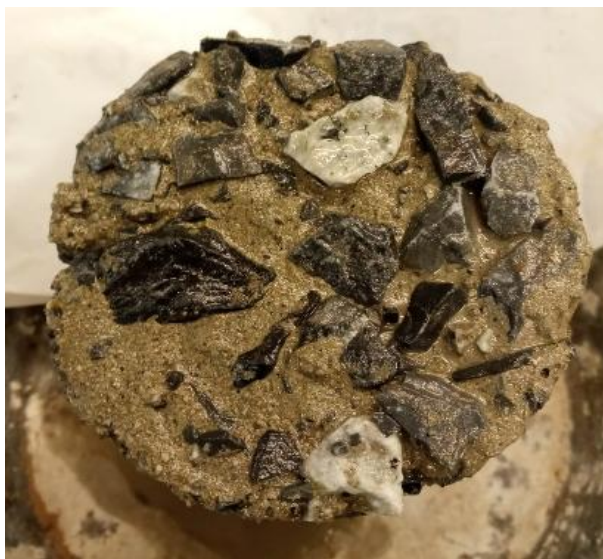
Figura 53: Sección transversal de una probeta de conductividad hidráulica correspondiente a una mezcla WR-T cercana a la razón de mezcla óptima. La imagen evidencia la reducción del área efectiva de flujo debido a la presencia de partículas gruesas y al relleno de vacíos por parte de la fracción fina.
