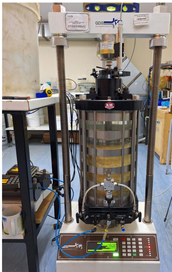
Figura 18: Sistema triaxial servo-controlado GDS utilizado para los ensayos CIU de gran escala sobre mezclas relave-estéril. El sistema considera una cámara triaxial de gran tamaño equipada con controladores automáticos de presión, celda de carga axial, sensor de presión de poros y monitoreo continuo de deformaciones.
