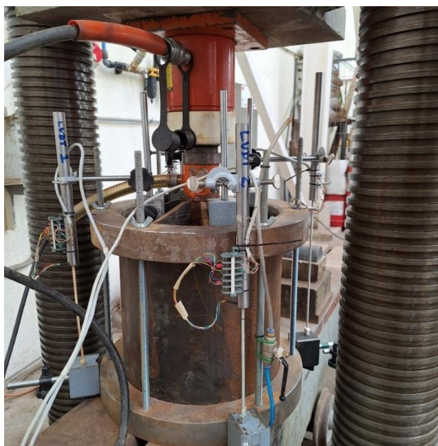
Figura 19: Sistema edométrico de gran escala utilizado para los ensayos de consolidación unidimensional sobre mezclas relave-estéril. El sistema considera un molde cilíndrico de 305 mm de diámetro, carga axial aplicada mediante cilindro hidráulico y monitoreo de deformaciones verticales mediante cuatro LVDTs distribuidos perimetralmente.
