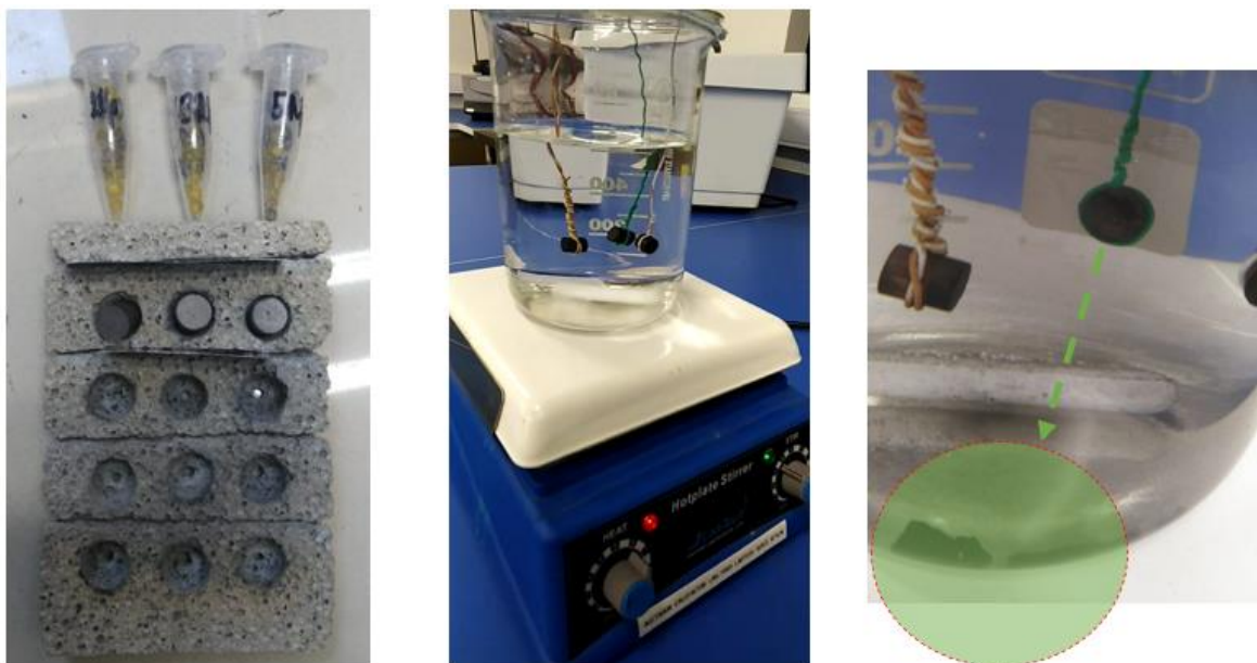
Figura 77: Muestras post sinterización y eliminación (fallida) de espaciador (NaCl) remanente con ciclo de figura 76.
