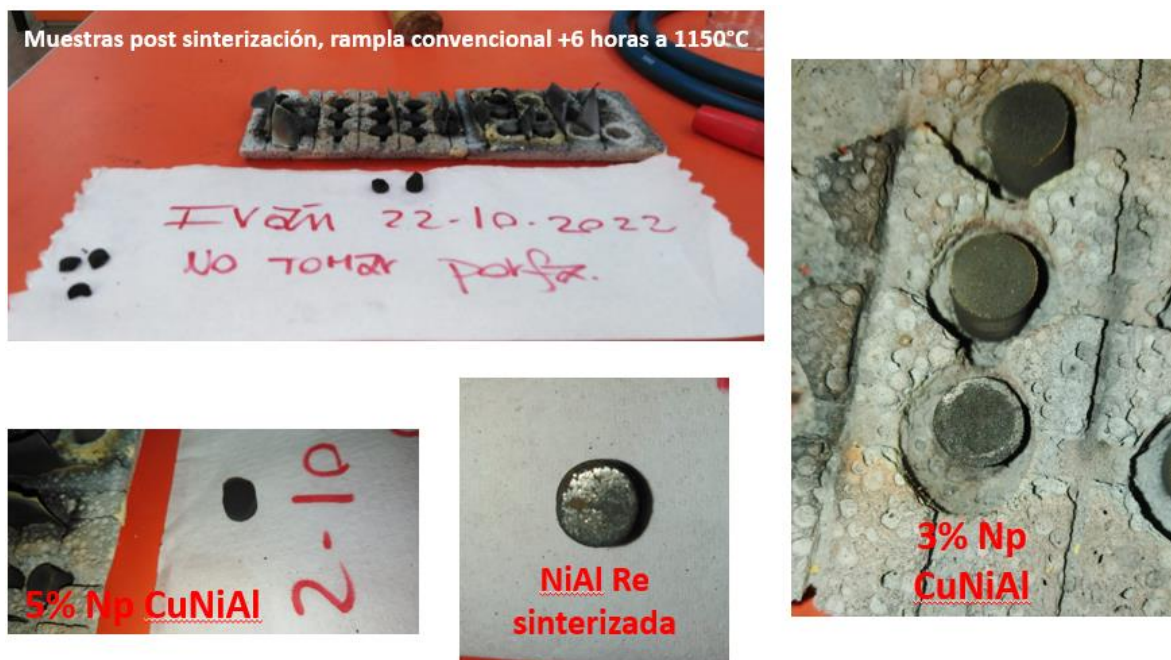
Figura 83: Muestras de Ni-5Al y CuNiAl con 3% y 5% de adición de NPs-CeO 2 sinterizadas utilizando el cuarto ciclo de sinterización (muestras con sinterización parcial).
