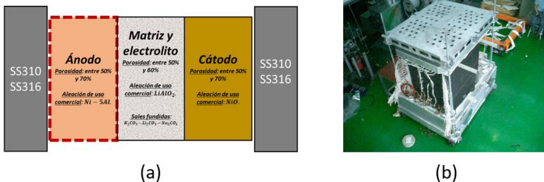
Figura 18: Materiales utilizados en MCFC (a) y celda MCFC piloto en KEPCO (b) [2,38].
