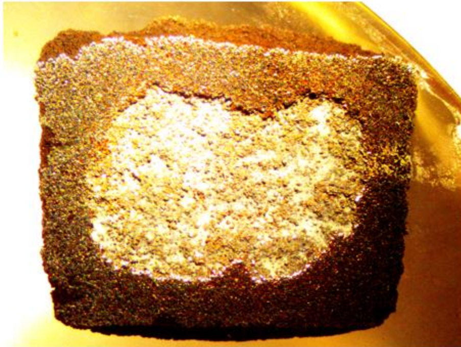
Figura 69: Muestra con 5% NPs-CeO 2 (CuNiAl+NaCl) compactada a 600 MPa en máquina universal.
