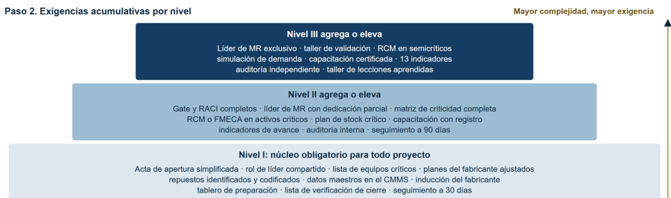
Figura 11. Clasificación del proyecto y exigencias acumulativas del Maintenance Readiness según su nivel de complejidad
