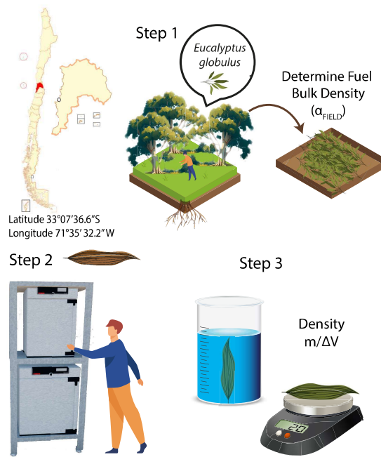
Figura 4.1: Procedimiento experimental desde la obtención de la muestra (paso 1) hasta el cálculo de su densidad (paso 3).
