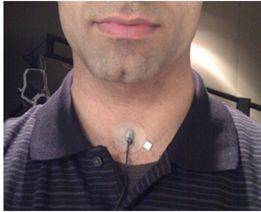
Figura 1.1: Acelerómetro puesto sobre la piel del cuello [16].
