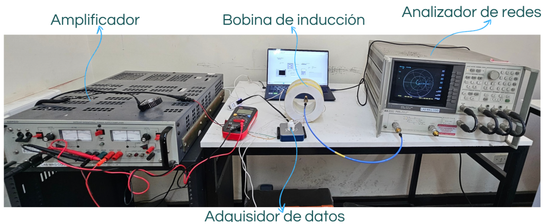
Figura 2.4: Sistema de medición de GMI con sus distintos dispositivos conectados
