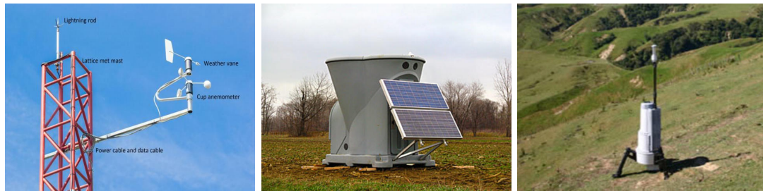
(a) Ejemplo de “met-mast”, (b) Modelo de SODAR (c) Modelo de LIDAR anemómetro de copa y veleta. comercial “Triton Sonic Wind Profiler”. comercial “ZephIR laser anemometer”
