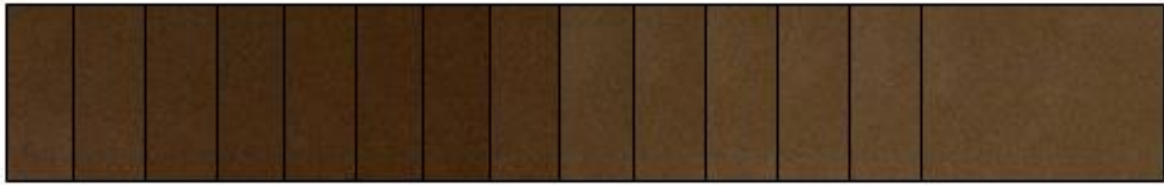
Fig. 4-13: Imágenes de sección de probeta desde un estado saturado (izquierda), hasta el estado seco (derecha).
