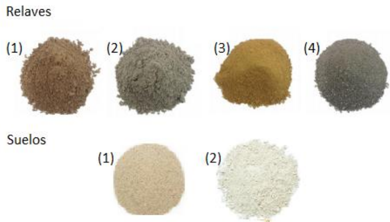
Fig. 4-1: Muestras de relave y suelo limpio utilizados en esta investigación.
