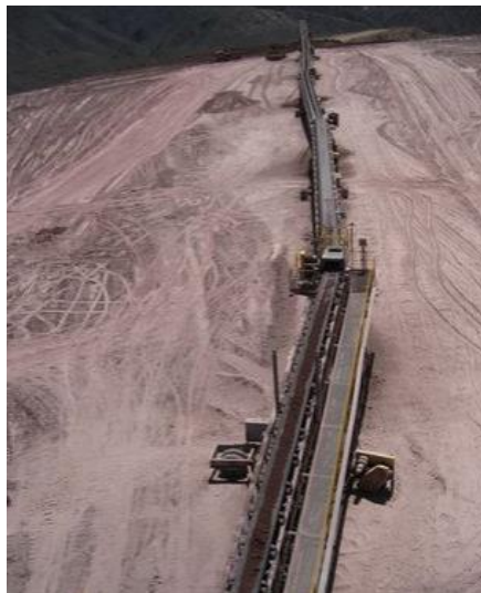
Fig. 3-12: Cinta transportadora de relaves filtrados. Fuente: Zuzunaga (2018).
