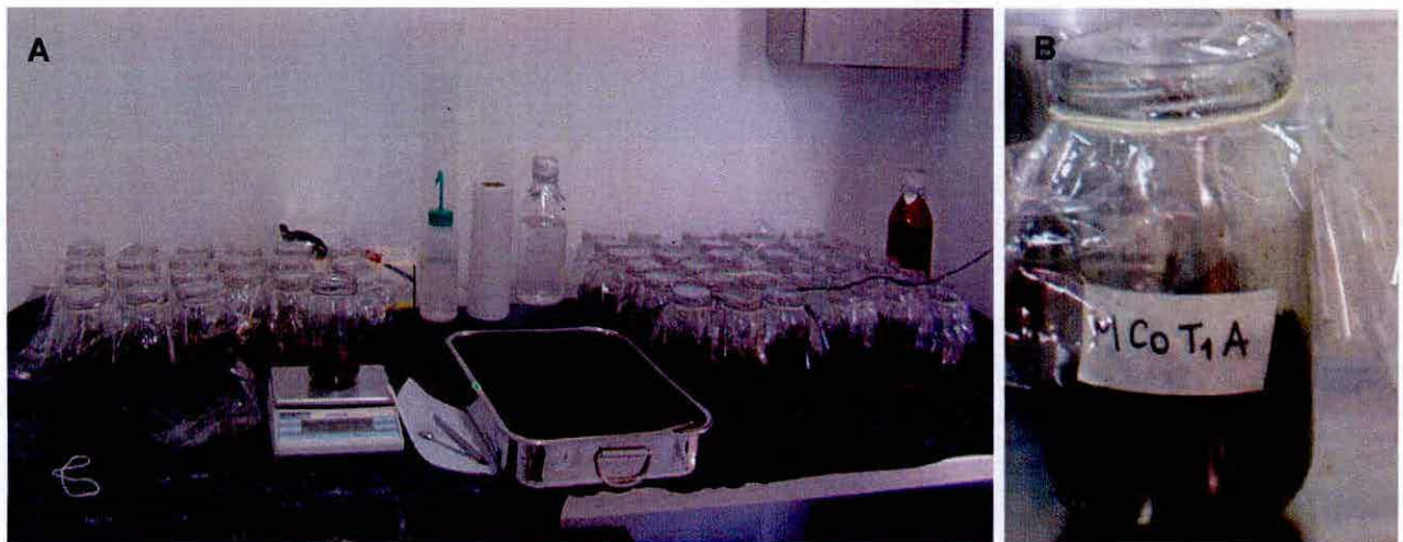
Figura 25. Microcosmos de suelo agrícola tipo A empleados en los estudios de biorremediación. A) Montaje del set de microcosmos. B) Imagen de un microcosmos conteniendo el suelo tamizado.
