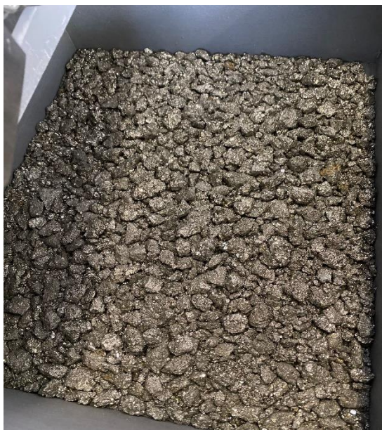
Figura 22: (a) Pirita triturada con la máxima apertura de chancador de mandíbula; (b) Molino de bolas.
