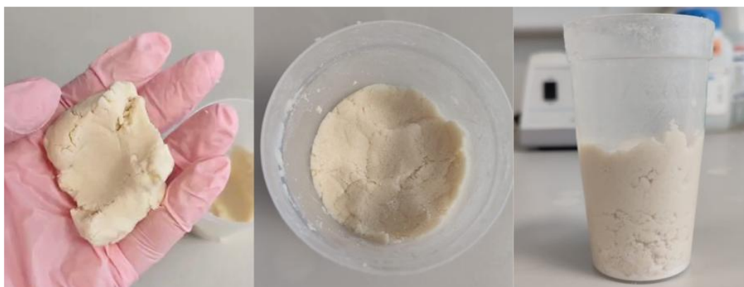
Figura 3-2: Matriz semisólida, plástica, y moldeable, con 50% p/p de hueso d_{50} = 10 [ \mu m] en una mezcla hueso-agua.
