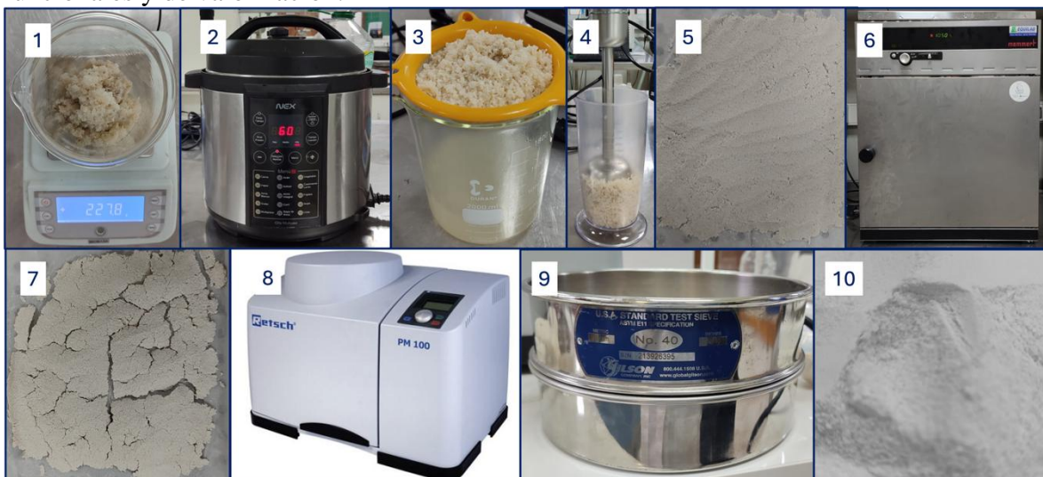
Figura 2-6: Proceso del tratamiento del hueso, posterior a la etapa de hidrolizado. (1) Materia prima (hueso hidrolizado). (2) Cocción de hueso de salmón en olla a presión. (3) Se separa el hueso sólido, del líquido luego de la etapa de cocción. (4) Una vez separado el hueso de la fase líquida se procede a una molienda con minipimer, donde se forma una pasta. (5)
