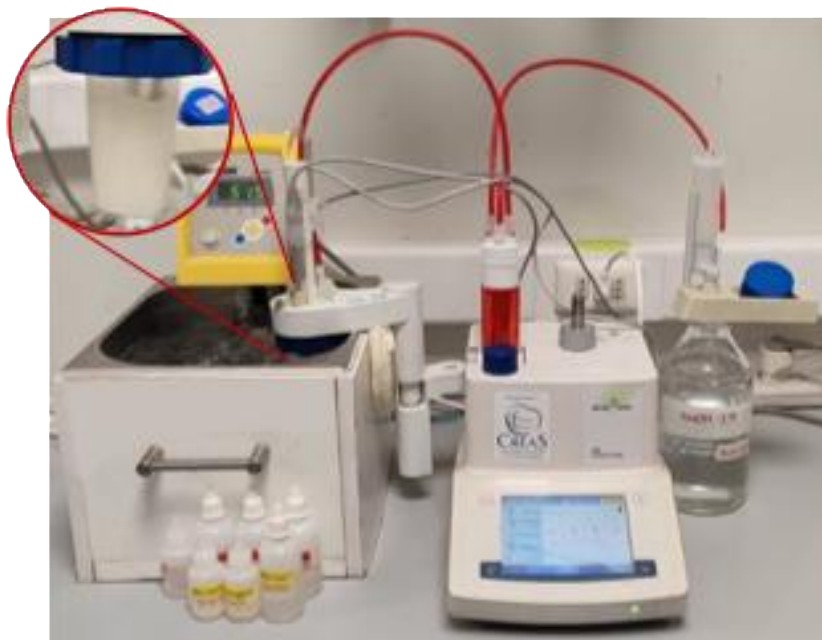
Figura 3-4: Montaje experimental para llevar a cabo las hidrólisis enzimáticas y la valoración de grupos \alpha -NH 3 mediante pH-stato, utilizando baño termostático y el equipo Mettler-Toledo G20.
