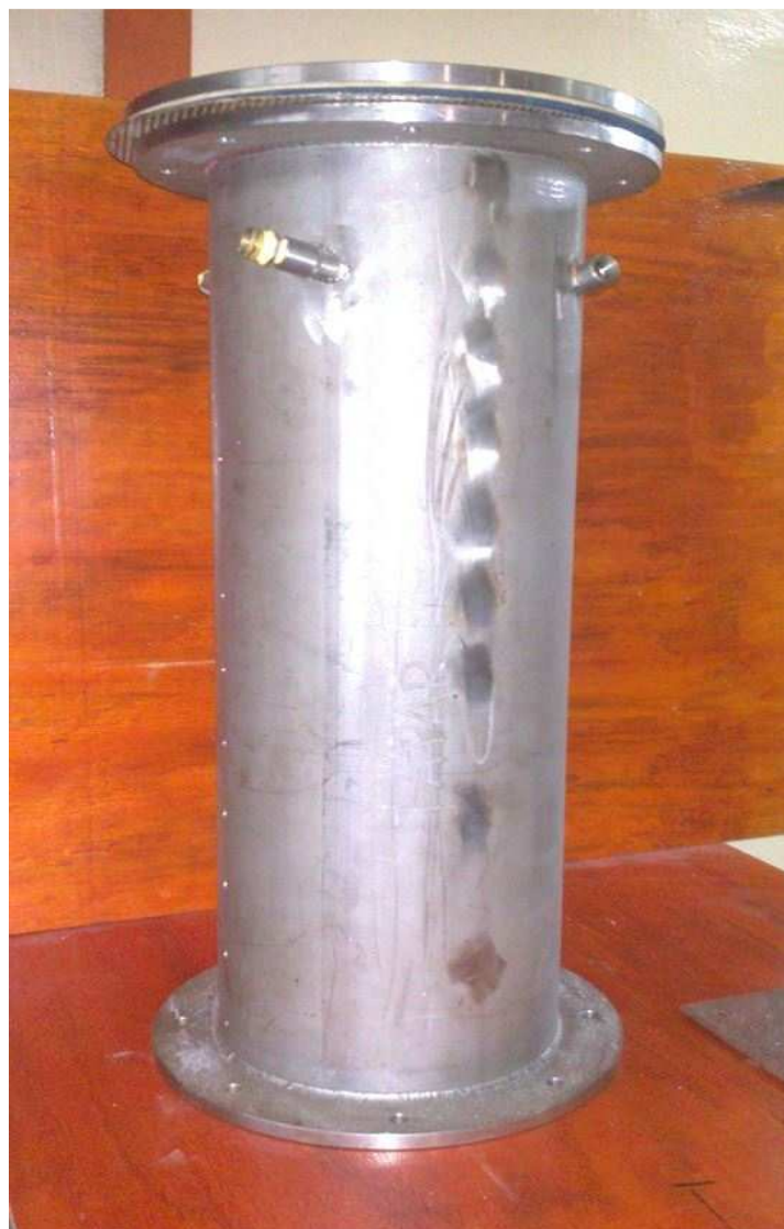
Figura 3.1: Esquema del reactor experimental de largo L = 0,6 m y diámetro D = 0,07 m.
