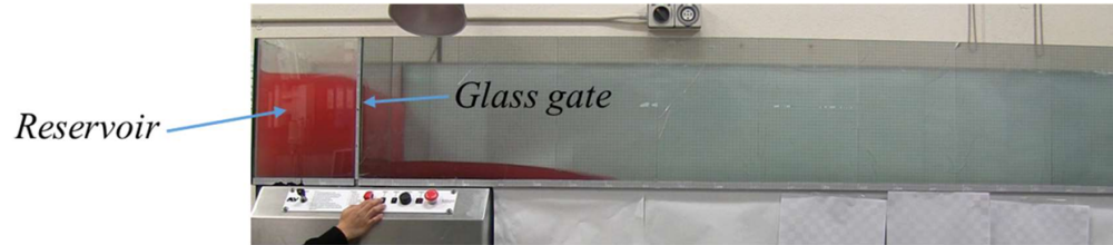
Figura 2.10: Vista frontal de instalación experimental con solución de carbopol usada por Liu (2018).
