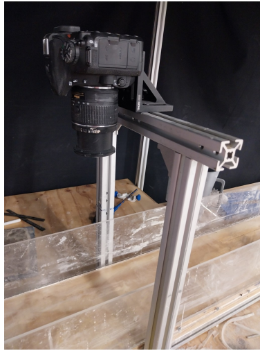
Figura 5.4: Cámara Nikon D7500, anclada a perfil de aluminio cercano a la compuerta de salida.
