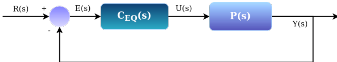
Figura 2.5: Esquema simplificado del controlador con predictor Smith.
