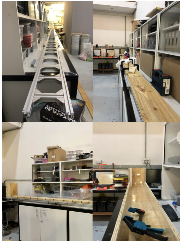
Figura 5.6: Construcción del canal rectangular.
