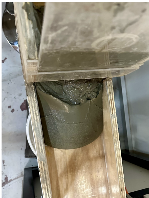
Figura 6.8: Comportamiento del flujo observado a una C_w = 75\% .
