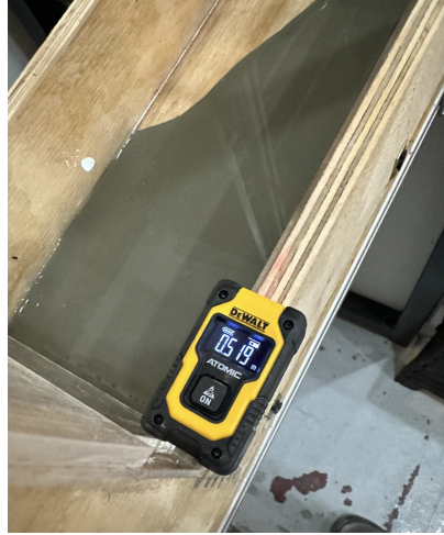
Figura 5.7: Láser utilizado para la medición de la distancia peligrosa.
