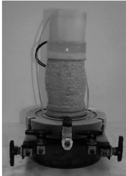
Figura 11-20: Muestra triaxial post-ensayo y congelación. Fuente: Jefferies y Been, 2016.
