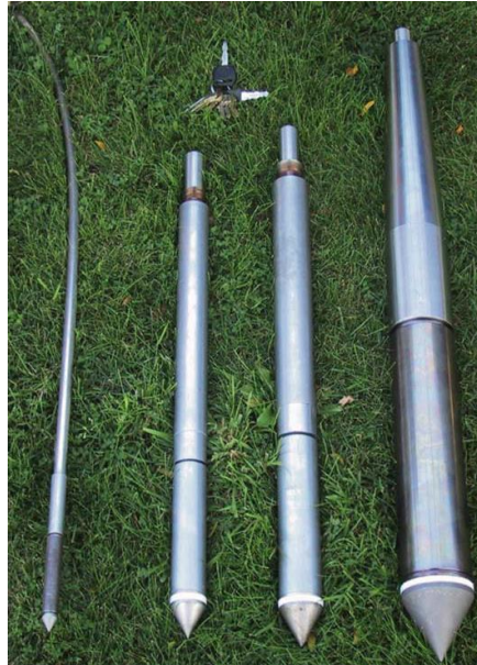
Figura 3-2: Diferentes tamaños de cono (de izquierda a derecha: 2, 10, 15 y 40 [cm 2 ]).
