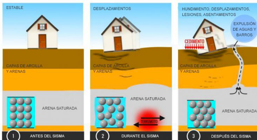
Figura 4-1: Licuefacción de arenas sueltas saturadas. Fuente: Geosec, 2015.
