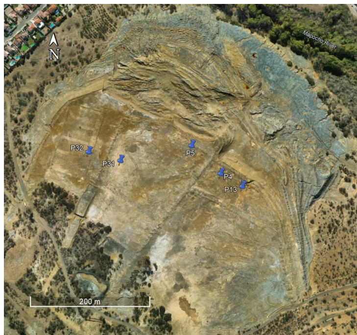
Figura 7-8: Ubicaciones ensayos CPTu en depósito Nro. 1.
