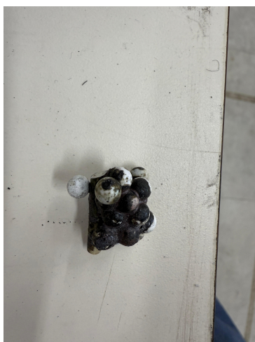
Figura 3.16: Aglomeración de partículas de alúmina observada posterior al proceso de co-combustión.
