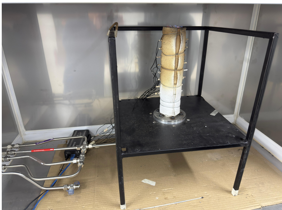
Figura 3.11: Instalación y conexión del reactor en las líneas de flujo.
