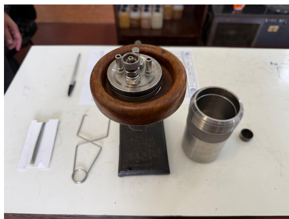
(b) Armado de la bomba del calorímetro.
