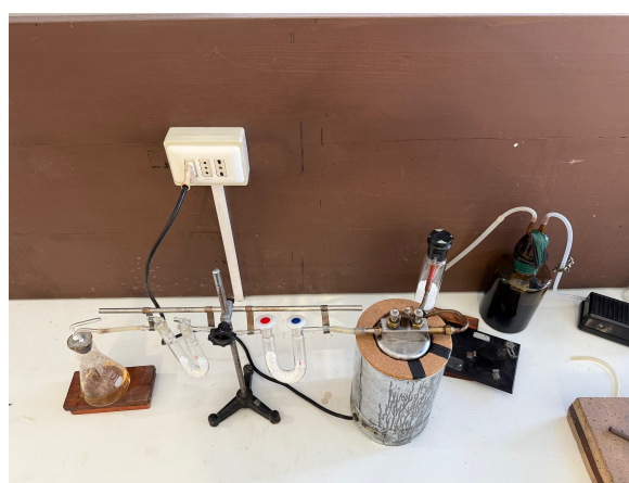
(d) Arreglo de trampas para el vapor de agua.
