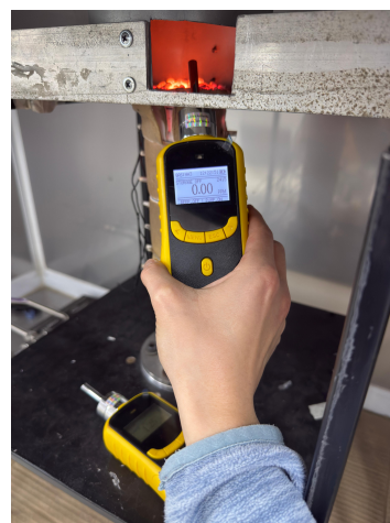
Figura 3.15: Sistema de medición de gases de salida durante la co-combustión.
