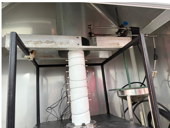
Figura 3.15: Sistema de medición de gases de salida durante la co-combustión.
