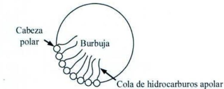
Figura 2.4 Adhesión de espumante a la superficie de la burbuja.
