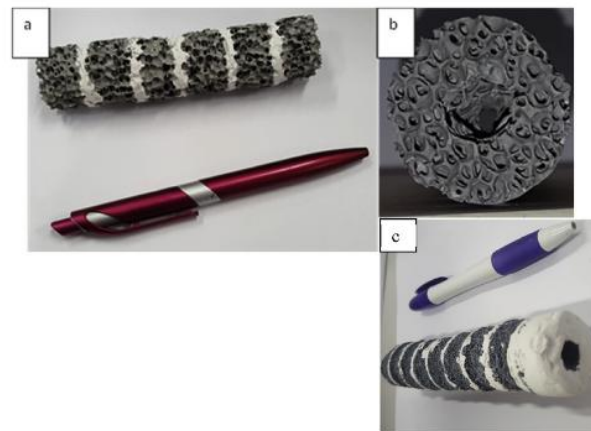
Figura 7. Montaje de medios porosos inertes como filtro de partículas (Meloni et al., 2019).
