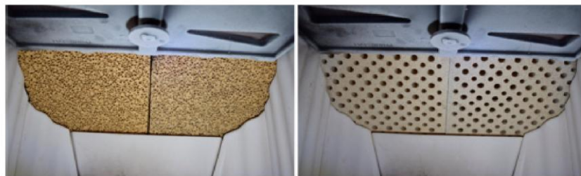
Figura 6. Filtro de espuma cerámica (izquierda) y dos placas de vermiculita (derecha). Esta última proporciona una resistencia al flujo similar que la espuma cerámica (Wöhler et al., 2017).
