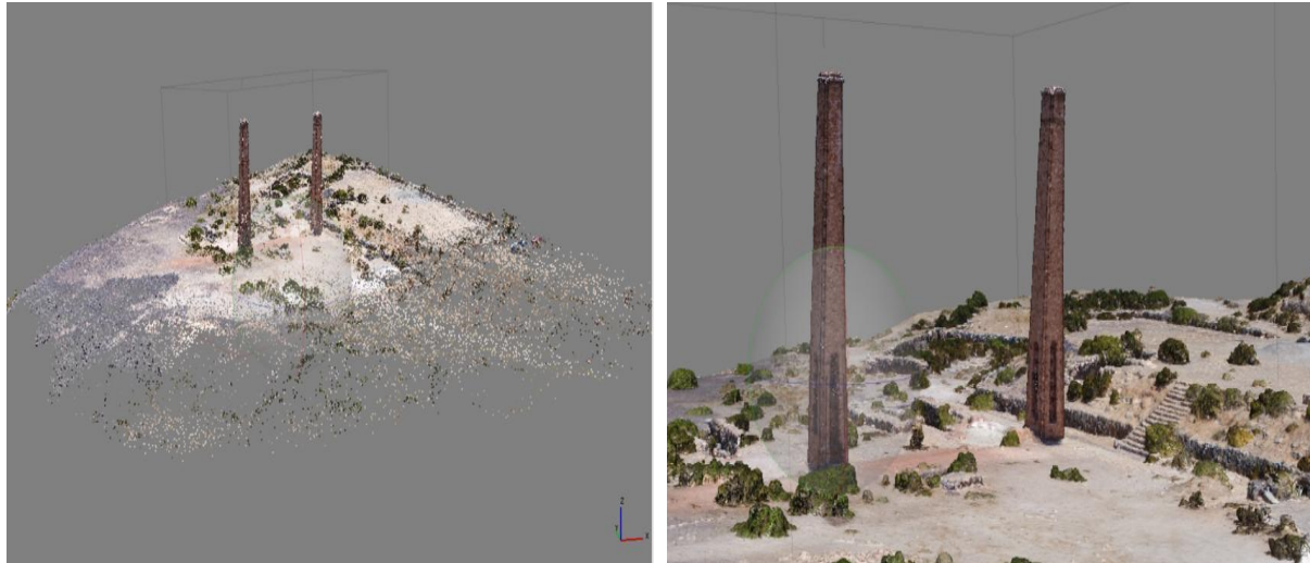
Figura 54 Imagen N° 1.- Modelo 3D de las Chimeneas de Labrar, generado a partir de un vuelo fotogramétrico y 9 puntos de control terrestre (GCP)." Fuente: Centro de Documentación (Cedoc), Consejo de Monumentos Nacionales
