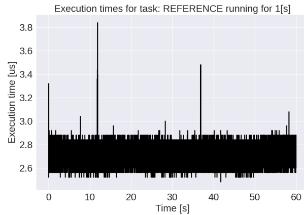
Fig. 4.34: Tiempo de ejecución de la referencia, considerando 1000 muestras por segundo.
