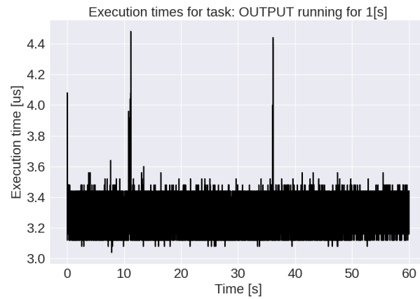
Fig. 4.35: Tiempo de ejecución de la actuación ( output ), considerando 1000 muestras por segundo.
